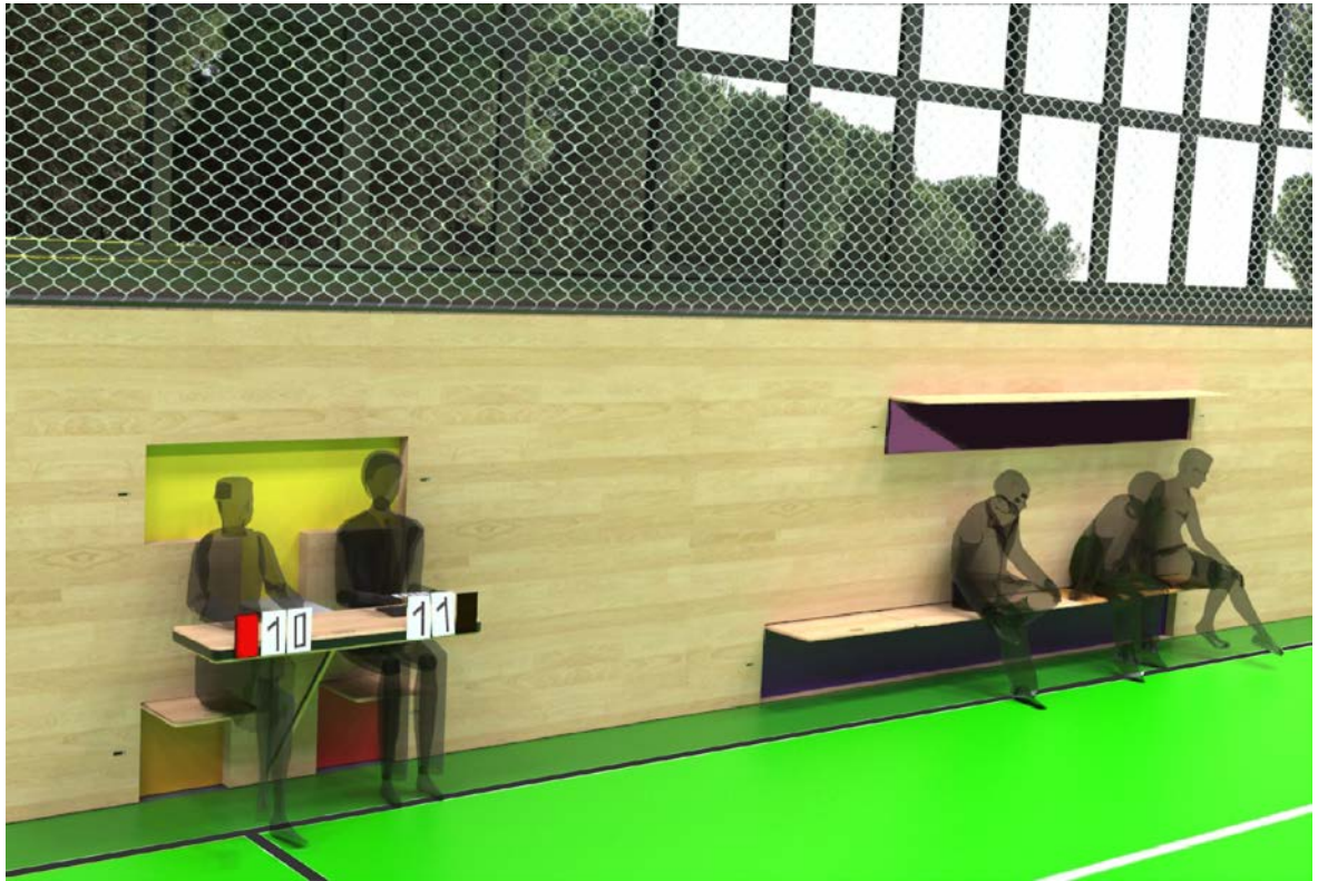
Obr. 41: Výklopná stěna - vyklopená
