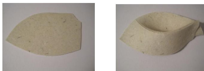
Obrázek 46 Tvarování nařezáním materiálu
