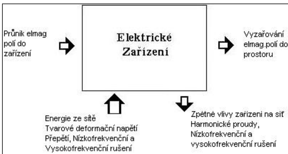
obr. 4 Vlivy působící na elektrické zařízení
