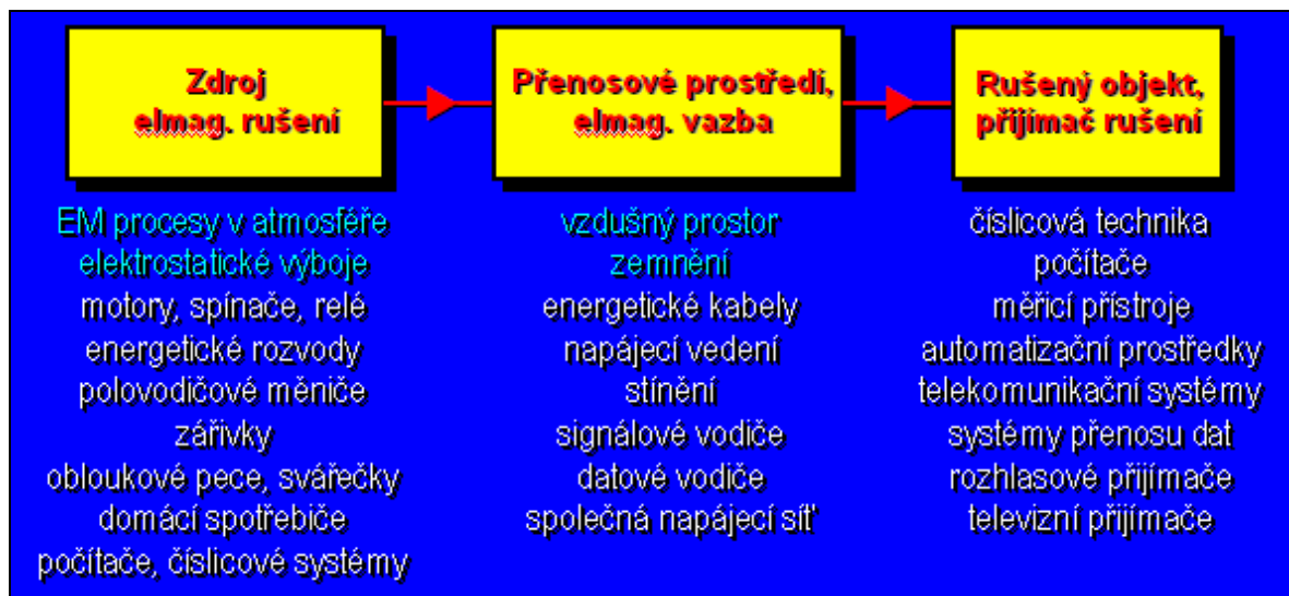
obr. 3 Základní řetězec EMC a příklady jednotlivých oblastí [1]
