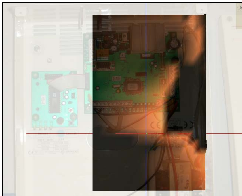
obr. 82 2. Překryv magnetického pole a skenované oblasti
