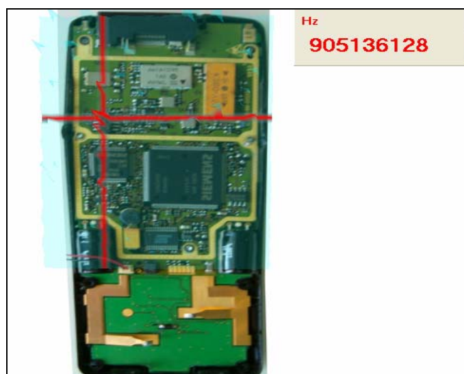
obr. 128 nalezení maximální intenzity magnetické složky
