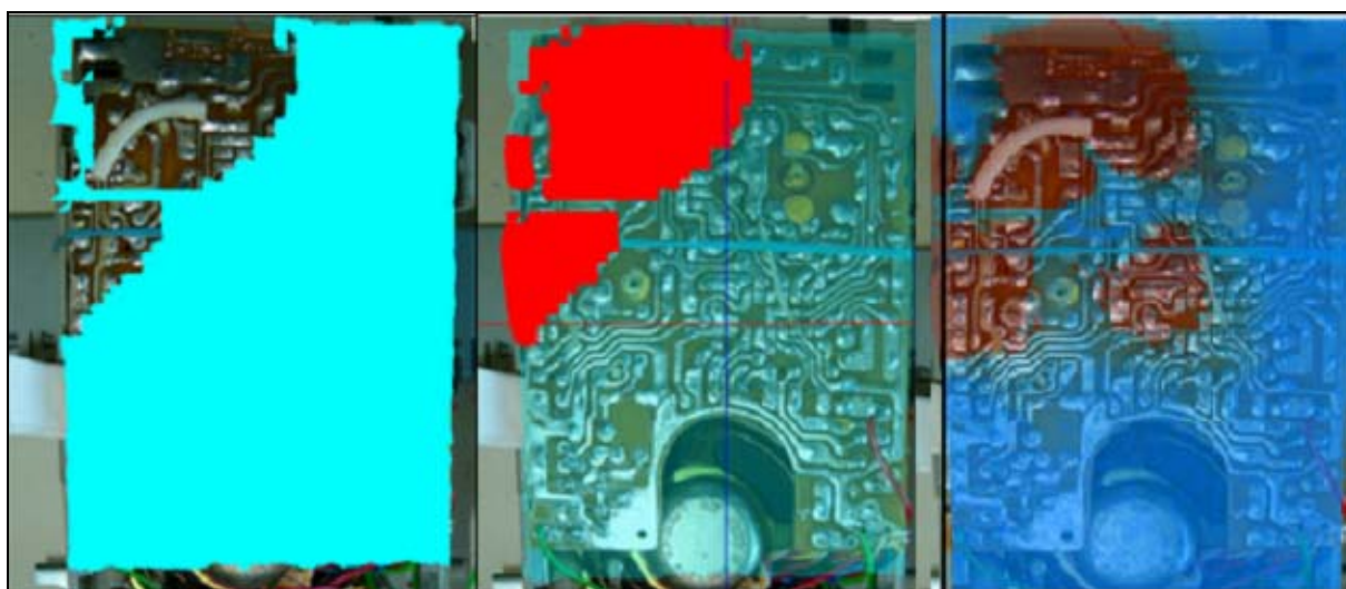
obr. 140 varianty zobrazení míst se zvýšenou intenzitou magnetické složky elektromagnetického pole na 115 MHz
