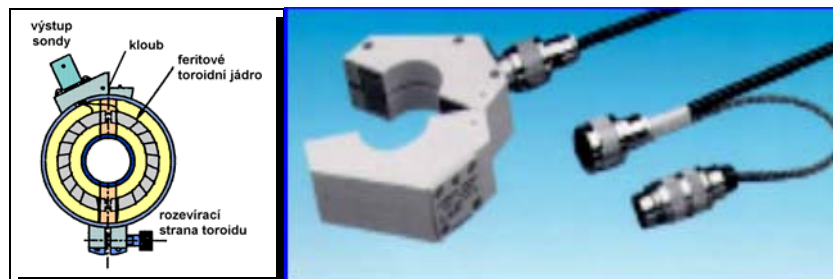
obr. 14 Konstrukce a vnější vzhled proudové sondy
