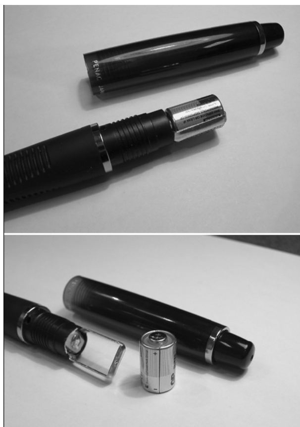
Obr. 10 Maskovaný vysílač MUD v kuličkovém peru
