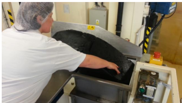
Obrázek 18 Přemísťování lékořicové hmoty do lisu. (Zpracováno na základě interního videa společnosti TCPSF, s.r.o.)
