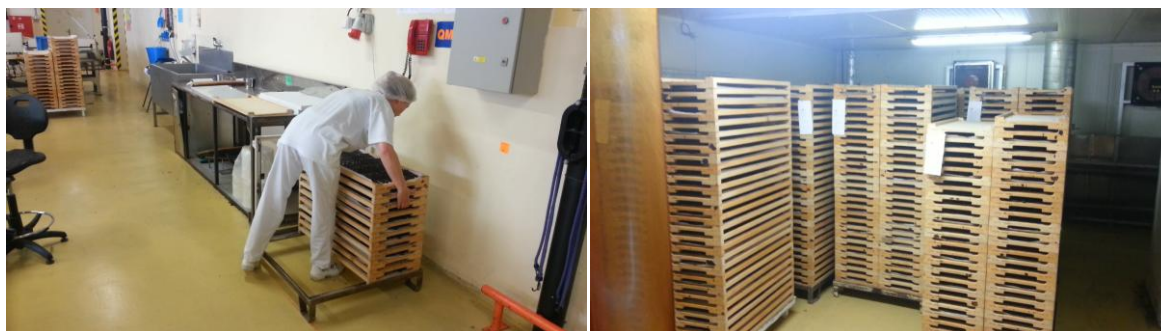
Obrázek 26 Stohování boxů a sušení. (Zpracováno na základě interního videa společnosti TCPSF, s.r.o.)
