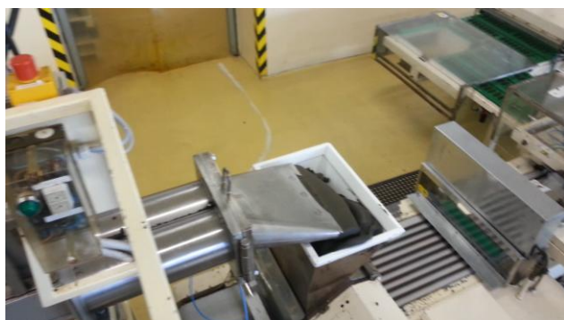
Obrázek 19 Tvarování lékořicové hmoty. (Zpracováno na základě interního videa společnosti TCPSF, s.r.o.)
