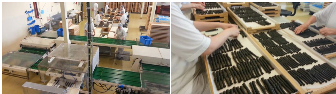
Obrázek 25 Ohýbání fajek do finálního tvaru. (Zpracováno na základě interního videa společnosti TCPSF, s.r.o.)
