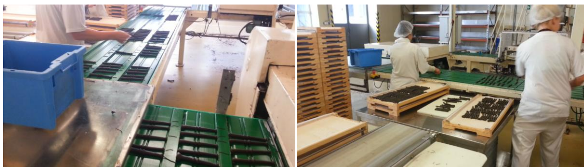
Obrázek 24 Přendávání fajek z výrob. pásu do boxů. (Zpracováno na základě interního videa společnosti TCPSF, s.r.o.)
