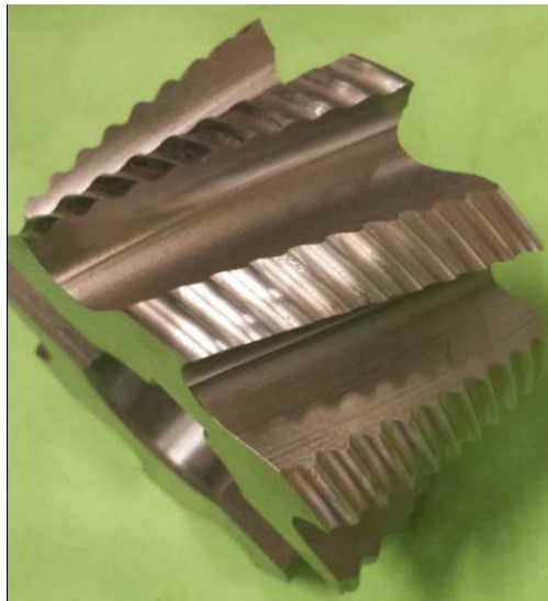
Obr. 32. Fréza s vyostřenými zuby na obvodě (vlastní zpracování)
