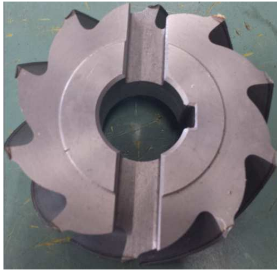
Obr. 29. Příčná drážka (vlastní zpracování)
