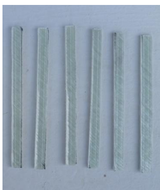
Obr. 39. Připravené vzorky pro zkoušku kyslíkového čísla
