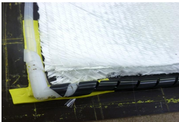
Obr. 20. Připevnění spirálové trubičky k formě
