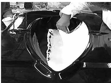
Obr. 6. Nátěr gelcoatu na formu [17]
