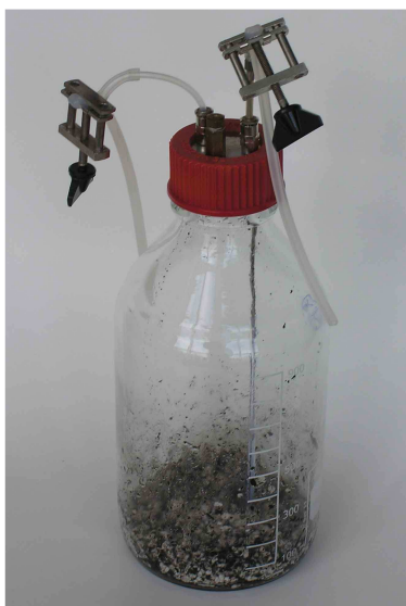
Obr. 8 Biometrická láhev pro sledování míry biodegradace polymerů, která je opatřena uzávěrem se septem pro odběr vzorku plynné fáze a dvěma dalšími otvory pro provzdušňování
