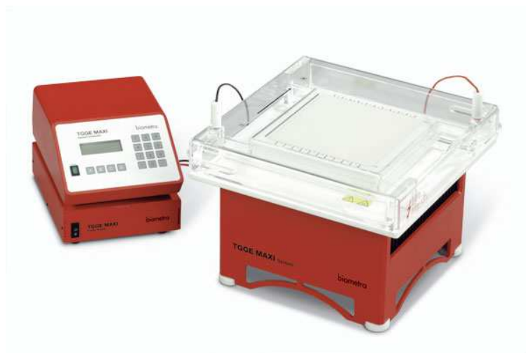
Obr. 9 TGGE Maxi Systém pro separaci PCR amplikonů
