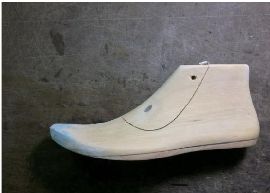
Obr. 50. Upravený tvar hranatého kopyta - zkosení
