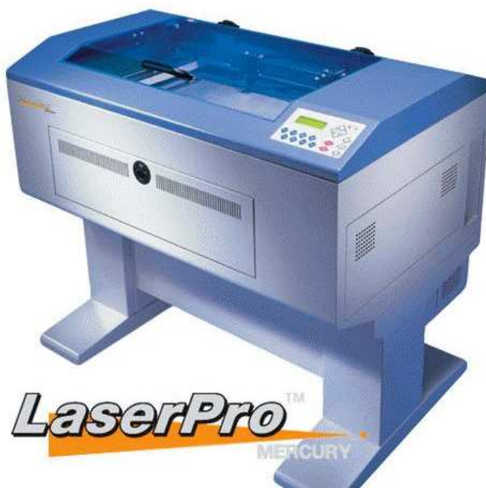
Obr. 16. CO 2 Laser Merkury L-30
