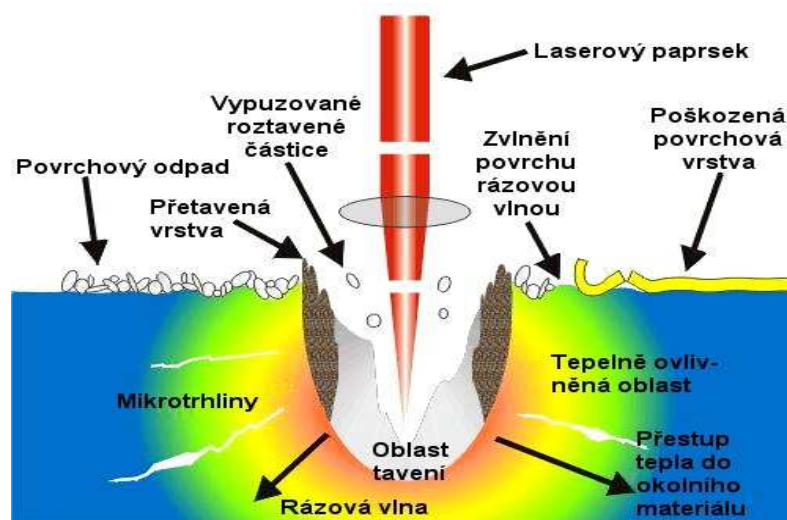
Obr. 9. Princip laserového mikroobrábění [2]
