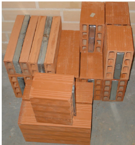
Obrázek 12 Cihly s výplní materiálu PCM [28]
