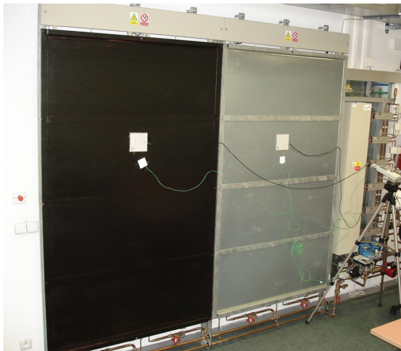
Obrázek 29 Sestava akumulčních panelů (natřený povrch) - měření tepelného toku a povrchové teploty
