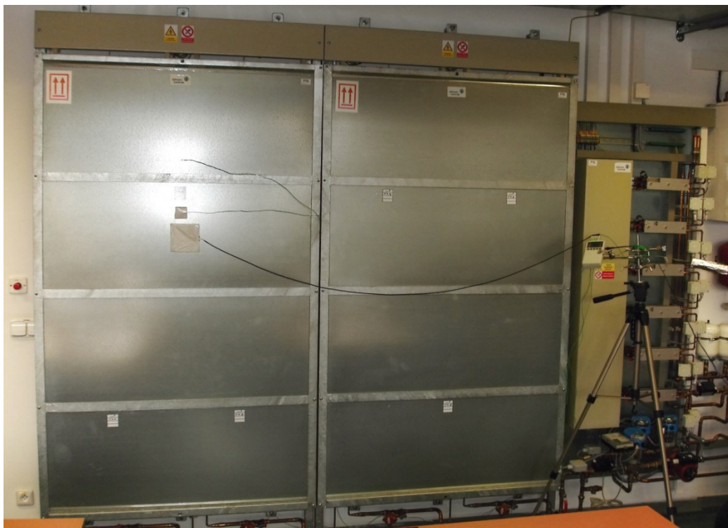
Obrázek 14 Soustava akumulčních panelů v laboratoři D307
