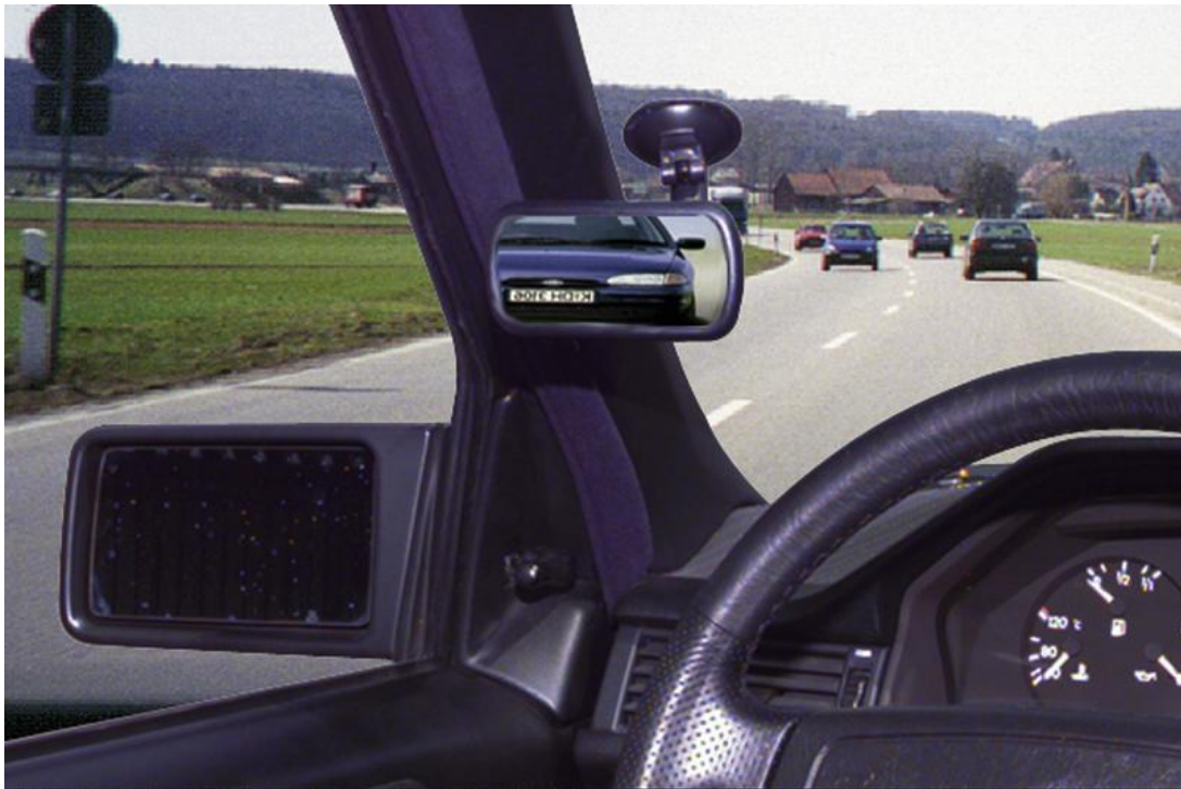
Obr. 12: Možnost zmenšení slepého úhlu pomocí přídavných zrcátek [16]
