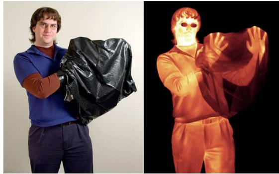
Obrázek 12: Ukázka propustnosti IR světla[16]
