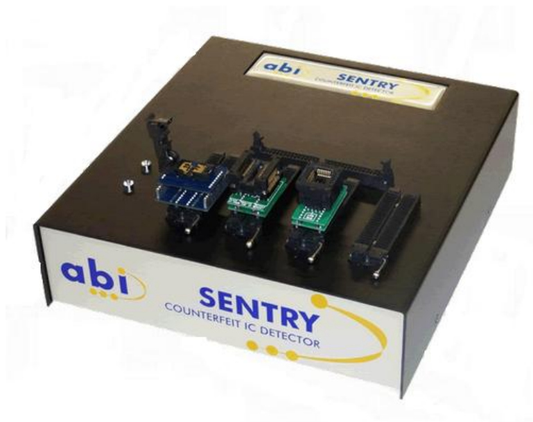
Obr. 35 SENTRY Counterfeit IC Detector se speciálními adaptéry pro různé typy pouzder. [34]
