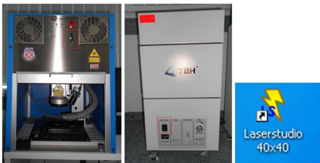
Obr. 25 Crow SE zapneme otočením klíče do polohy Start (vlevo), odsávání zapneme přepnutím vypínače do polohy I (uprostřed), ikona Laserstudio (vpravo).
