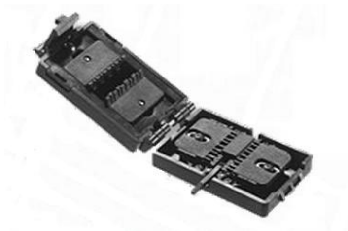
Obr. 36 Univerzální adaptér pro pouzdra typu SOIC. [35]
