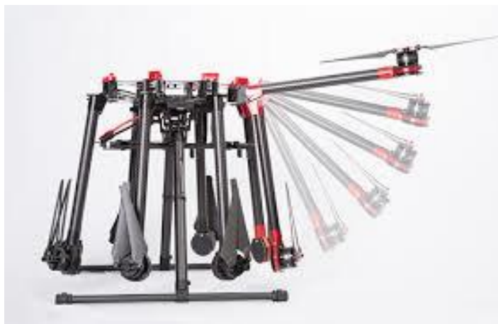
Obrázek 15: Složený rám DJI S1000, rám se využívá pro nošení kamer a zrcadlovek pro profesionální natáčení a focení [23]
