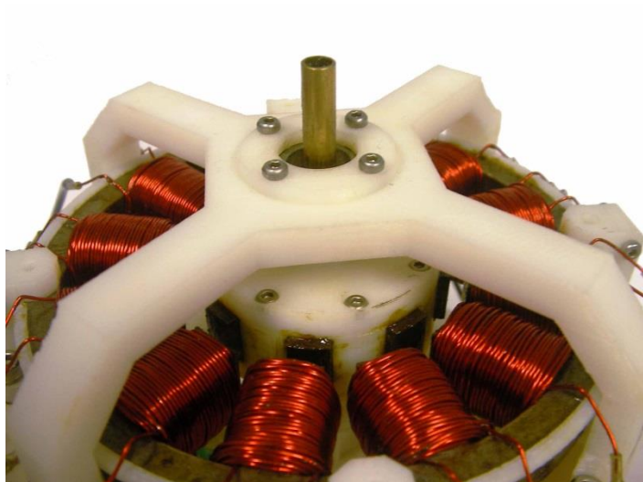
Obrázek 16: Konstrukce inrunner BLDC motoru [24]
