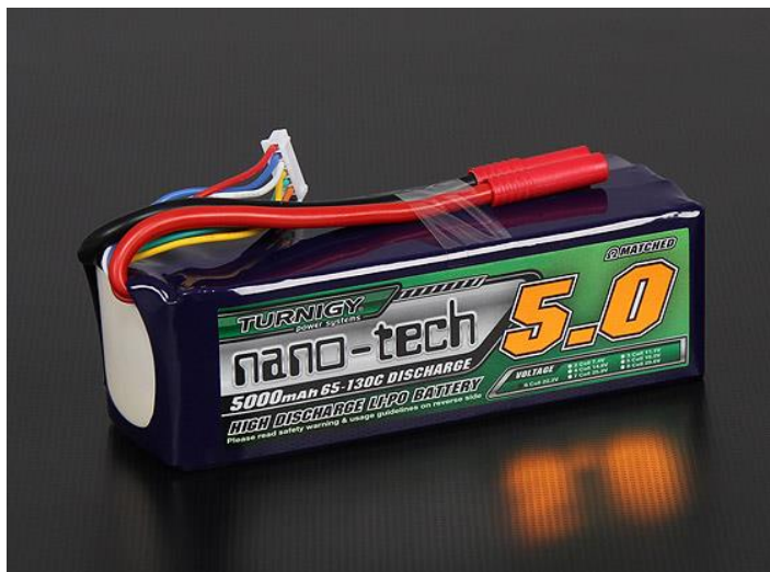
Obrázek 21: Li-Polymerová baterie Turnigy Nanotech, nominální napětí 22,2V s kapacitou 5000 mAh s vybíjecími proudy 325A (650A do 5s) [29]
