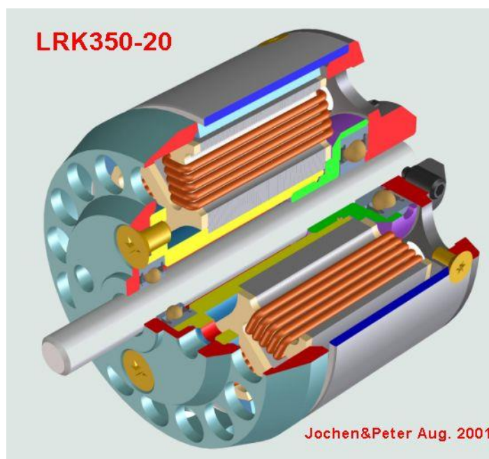
Obrázek 17: Konstrukce outrunner BLDC motoru [25]
