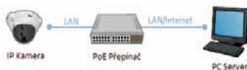
Obrázek č. 6 - Zapojení IP kamery prostřednictvím PoE [5], [25]
