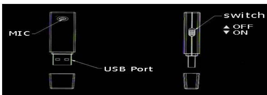
Obrázek č. 32 - Jednotlivé funkce záznamového zařízení [31]
