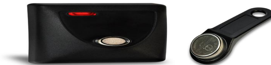
Obrázek č. 23 - EDK4 – venkovní čtečka antivandal kontaktní a kontaktní čip DALLAS DS1 990A-F5 s plastovou klíčenkou [29]
