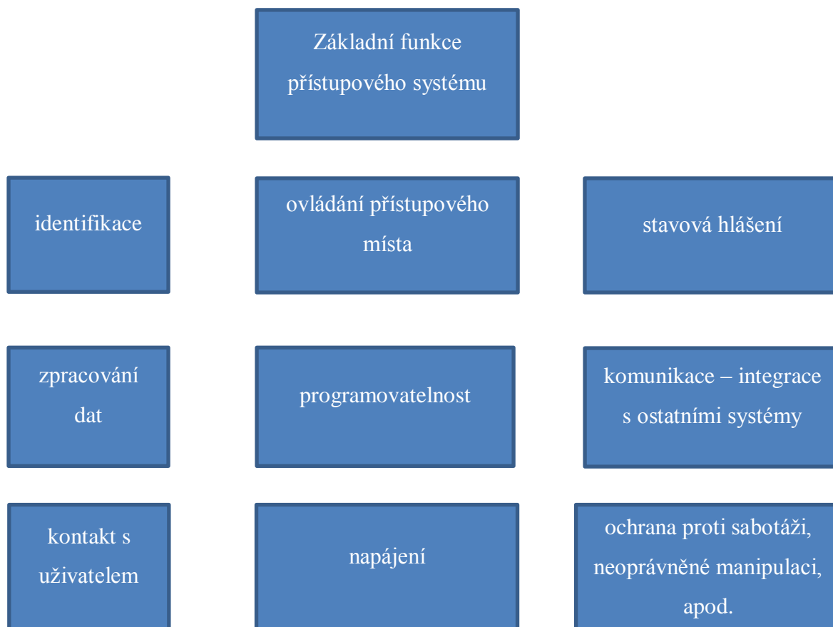
Obrázek č. 10 - Složení přístupového systému [zdroj: autor]
