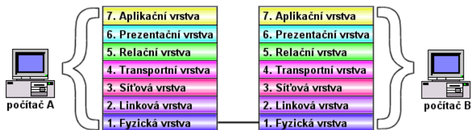
Obrázek 6 – Vrstvy modelu OSI [20]
