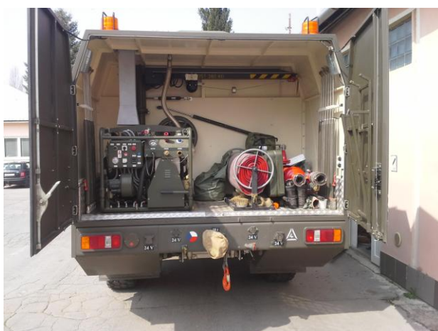
Obrázek 12. Dekontaminační zařízení SANIJET C-921. [Zdroj: vlastní]
