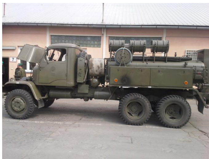
Obrázek 13. Chemický automobil rozstřikovací ARS-12M. [Zdroj: vlastní]
