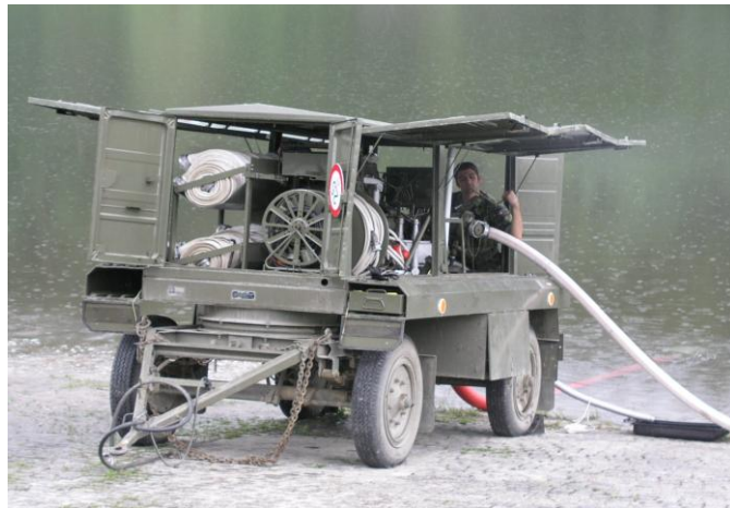
Obrázek 14. Přívěs linky-82 s čerpadlem. [Zdroj: Centrum odborné přípravy chemického vojska. LINKA – 82. Vyškov, 2005.]
