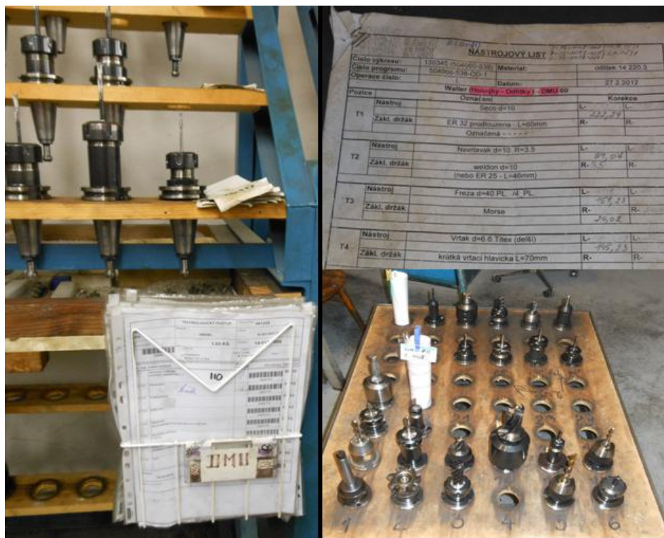
Obr. 23 Vychystané nástroje dle nástrojového listu (Vlastní zpracování)
