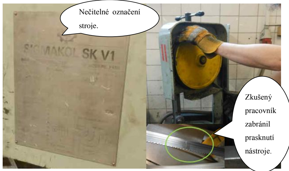
Obr. 22 Označení stroje a výměna nástroje při opotřebení (Vlastní zpracování)
