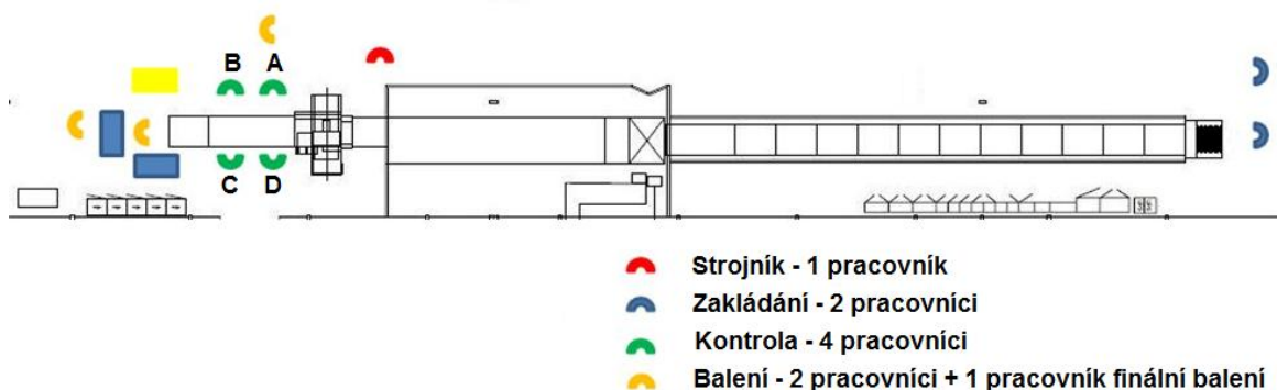
Obrázek 6 - Layout pracoviště průběžné temperační pece (vlastní zpracování)
