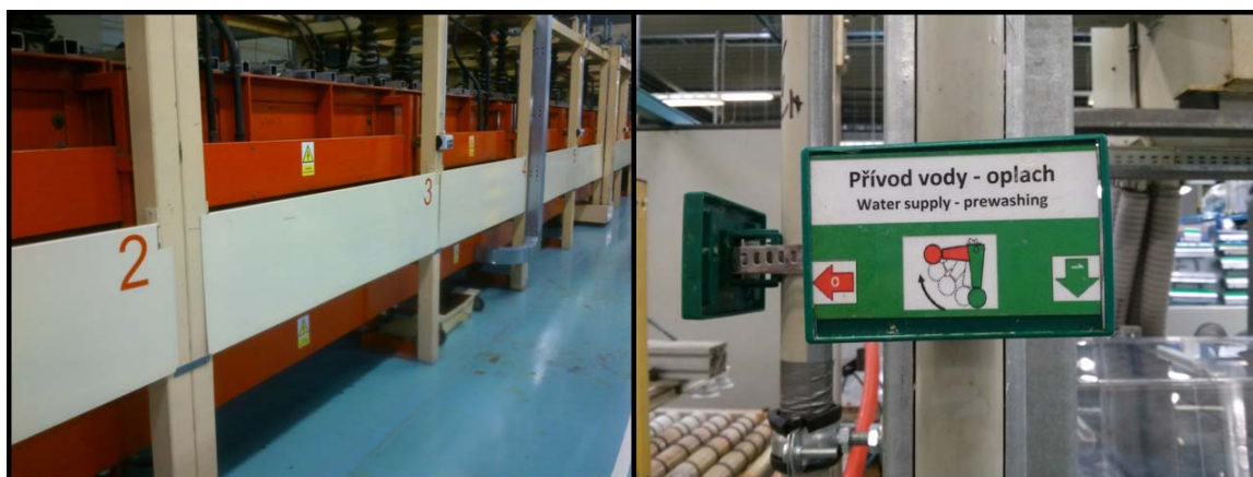
Obrázek 26 – doplněné označení sekcí pece a přívodního kohoutu (vlastní zpracování)
