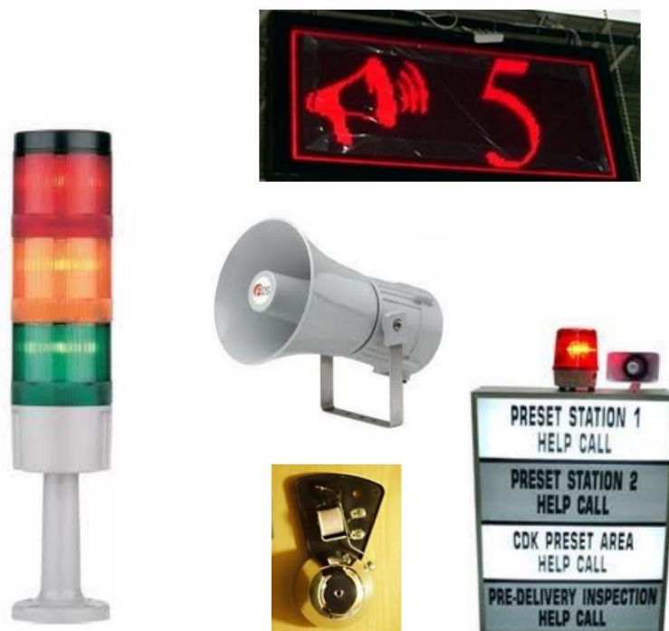
Obr. 8. Typy andon prostředků (Vavruška, 2011)
