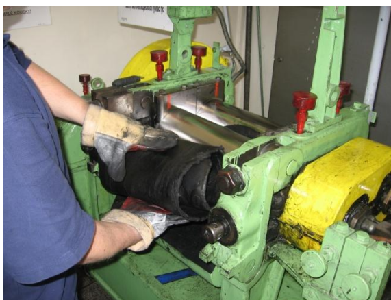
Obr. 10. Kalandrování nánosovací směsi
