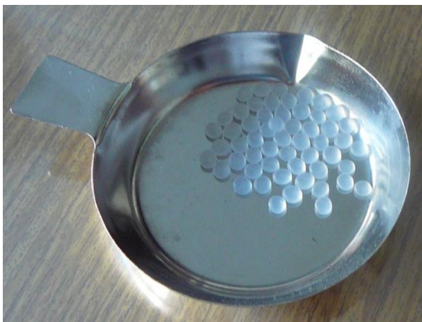
Obr. 17 Navážka granulátu PB-1
