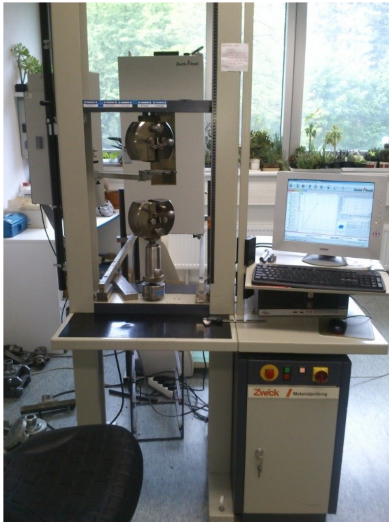
Obrázek 29 Univerzální zkušební stroj Zwick 1456.
