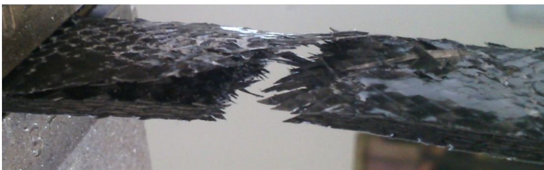
Obrázek 34 Detailní pohled na způsob porušení vzorků při zkoušce A2.
