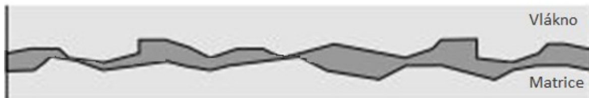
Obrázek 13 Znárodnění styčných ploch rozhraní vlákno-matrice. [4]
