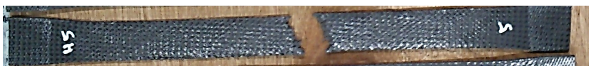
Obrázek 32 Pohled na roztržený vzorek po zkoušce A2.
