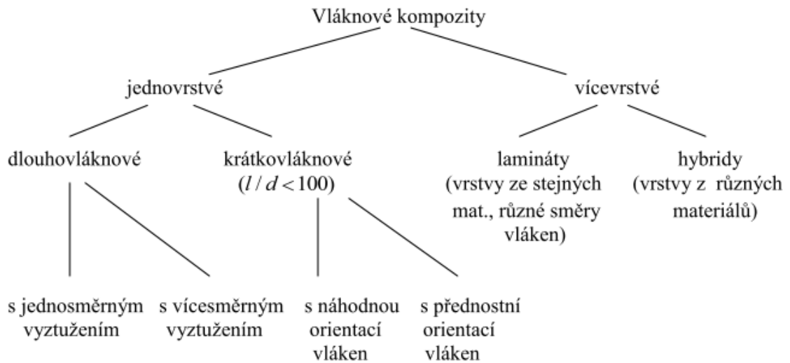
Obrázek 6 Klasifikace vláknových kompozitů z geometrického pohledu. [12]
