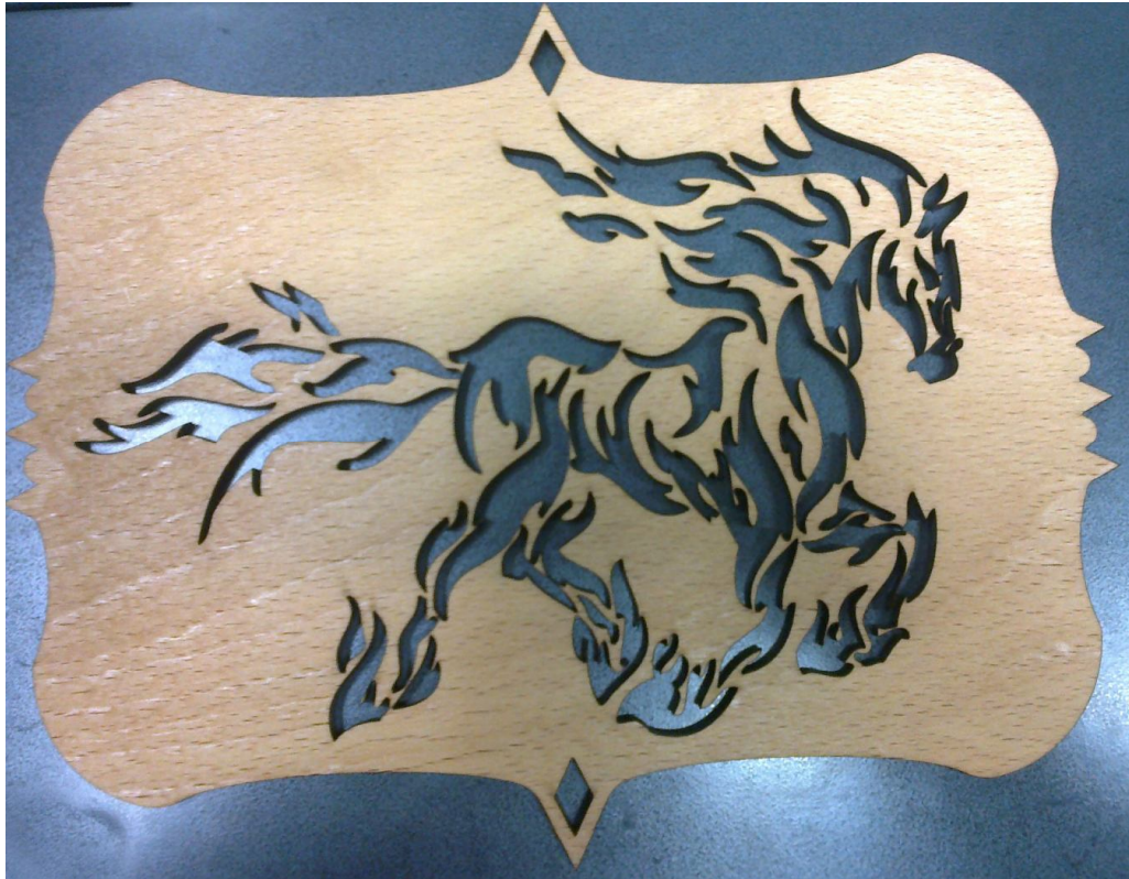
Obr. 10. Laserové vyřezání překližky na CO 2 laseru.
