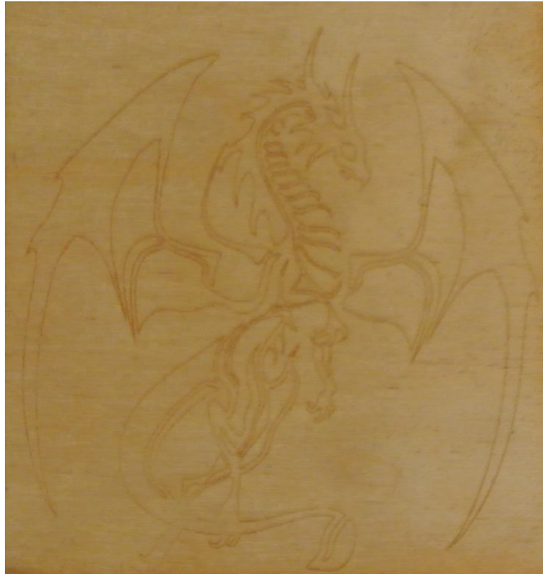
Obr. 13. Laserové gravírování na CO 2 laseru.
