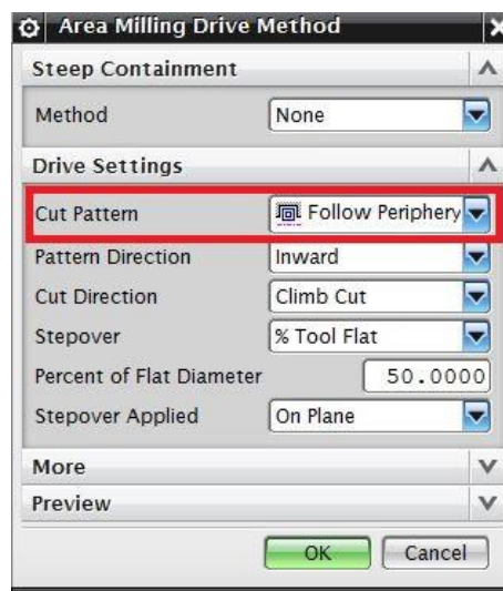
Obr. 38. Nastavení metody obrábění – dokončení čelních ploch
