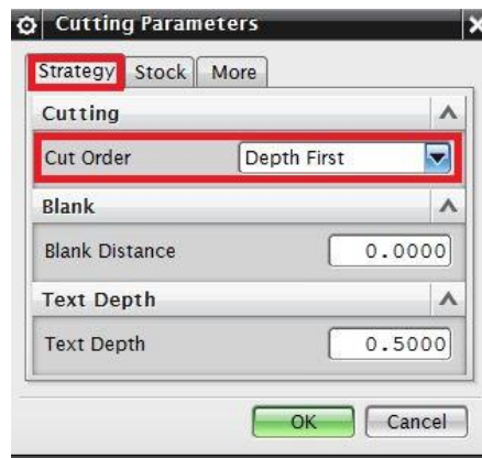
Obr. 55. Nastavení řezných parametrů - gravírování
