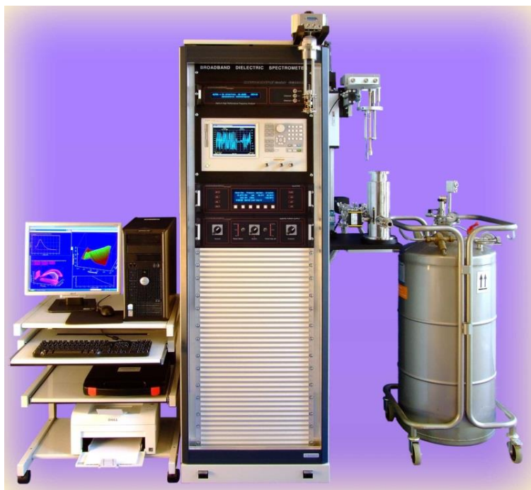
Obrázek 8–6 Celkový pohled na aparaturu (včetně chladicího systému) pro měření dielektrických vlastností materiálů.
