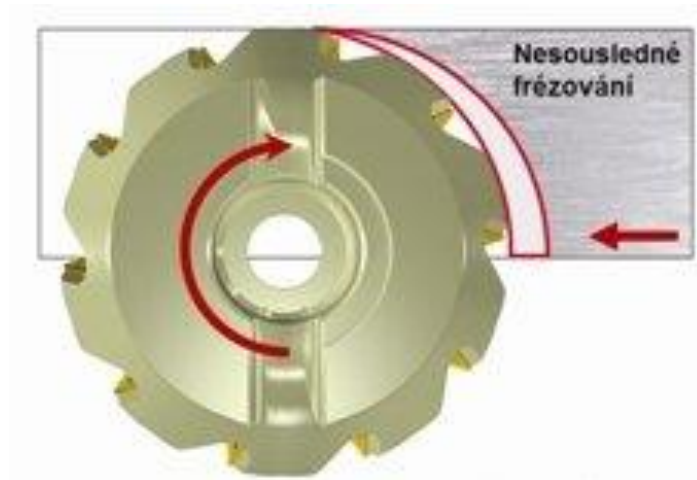
Obr.11 Průběh nesousledného frézování [18]
