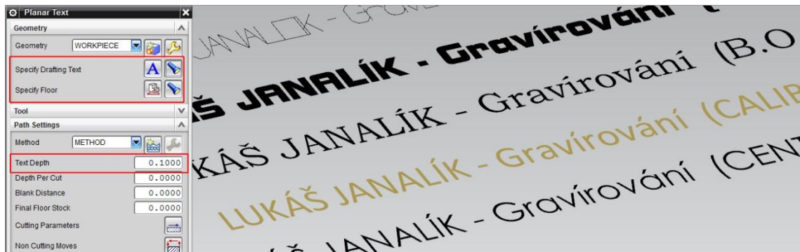
Obr. 73 Nastavení operace Planar Text pro gravírování textu do hloubky 0,1 mm
