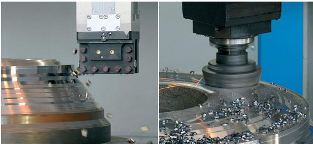
Obr. 20 Správný odvod třísek je důležitým faktorem při obrábění [20]
