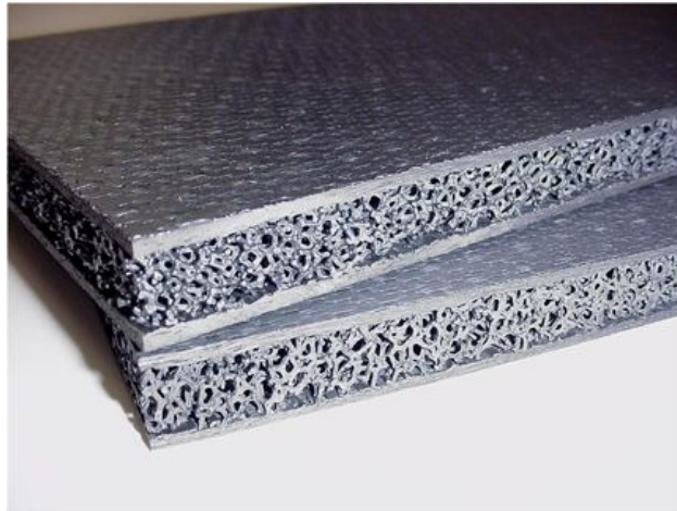
Obr. 13. Sendvičová konstrukce s pěnovým jádrem [18]
