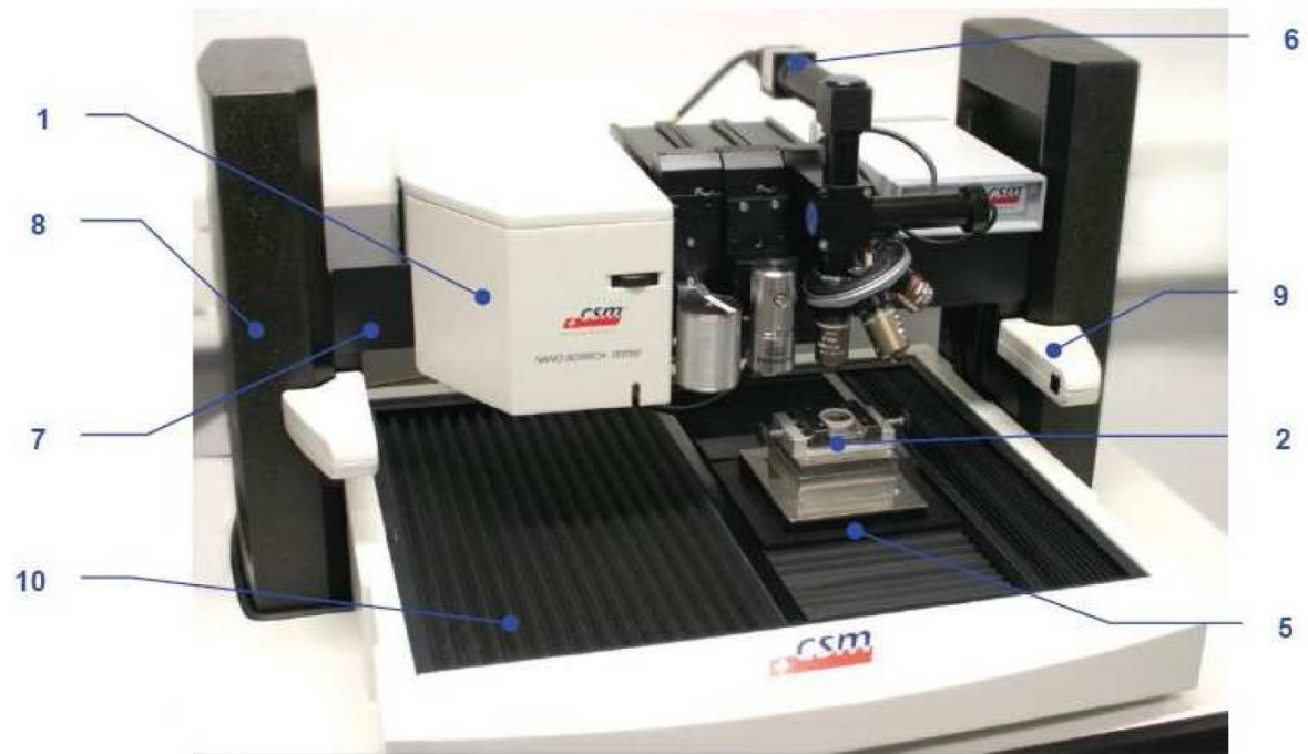
Obr. 9-1 Nanotvrdoměr NHT2 – Opx/Cpx (1 - měřící hlava; 2 – univerzální držák; 5 – podstava; 6 – optický mikroskop; 7 – modulová hlava; 8 – antivibrační stojan; 9 – optický senzor; 10 kryt stolu)
