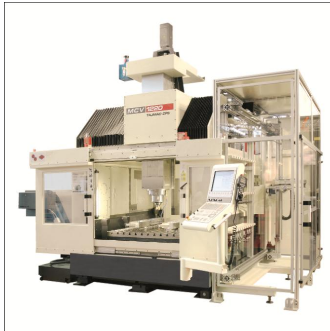
Obrázek 14: Vertikální centrum MCV 1220 typ horní gantry (Interní materiály společnosti)
