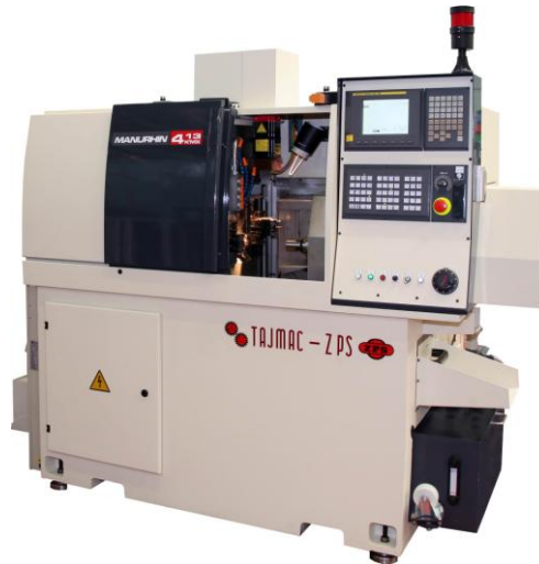
Obrázek 16: Dlouhotočný automat Manurhin K'MX 413 (Interní materiály společnosti)
