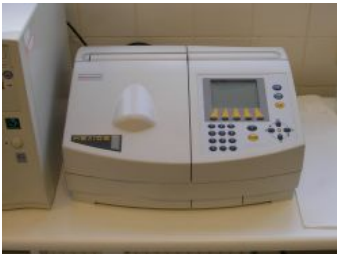
Obrázek 4: UV-VIS-spektrofotometr (Helios Alpha)[16].
