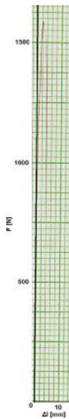
Obr. 57. Grafické zobrazení tahové zkoušky pro PP + 30 % GF (60°C)
