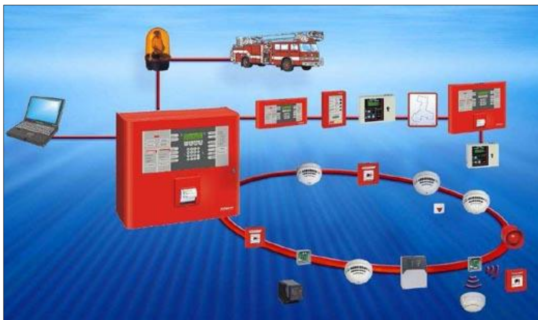
Obr. 14. Elektronická požární signalizace
