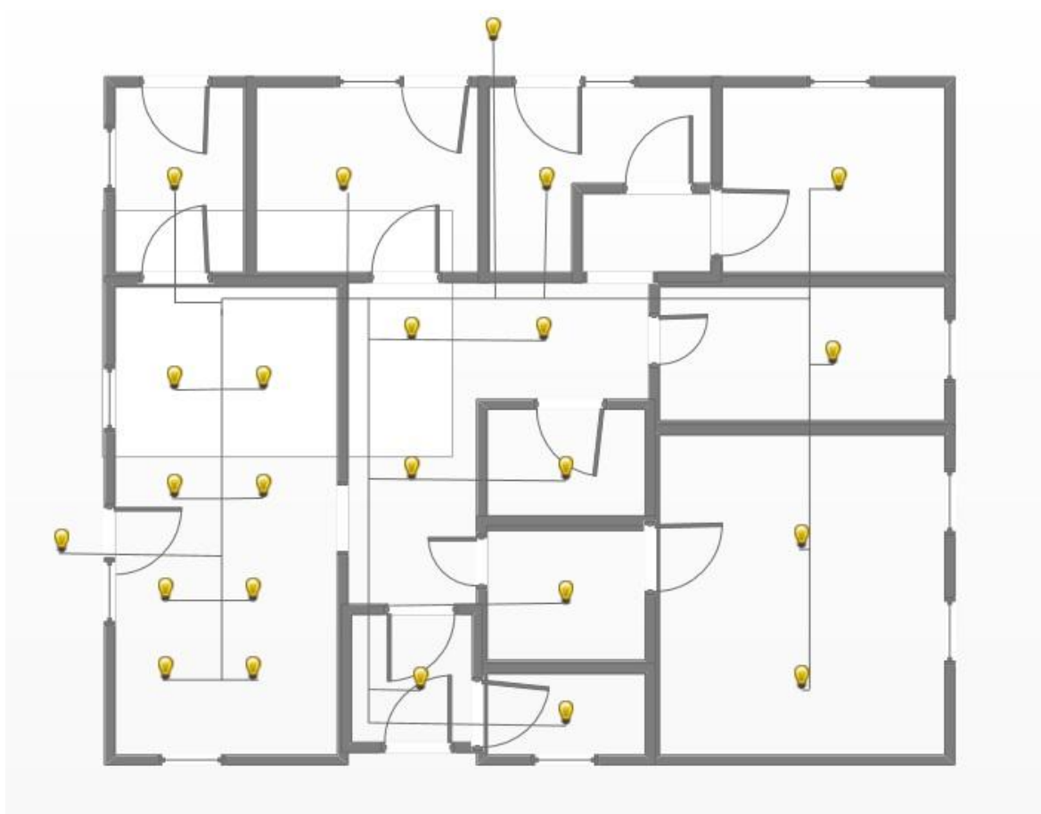
Obr. 35. Návrh osvětlení pomocí elektroinstalace KNX
