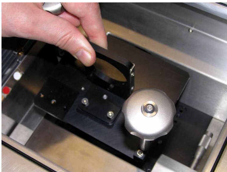
Obrázek 43 Instalace přenosového modulu do komory vzorku. [Terahertz equipment, 2013]
