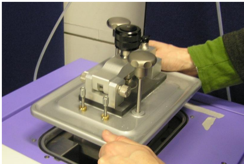
Obrázek 46 Instalace ATR modulu. [Terahertz equipment, 2013]
