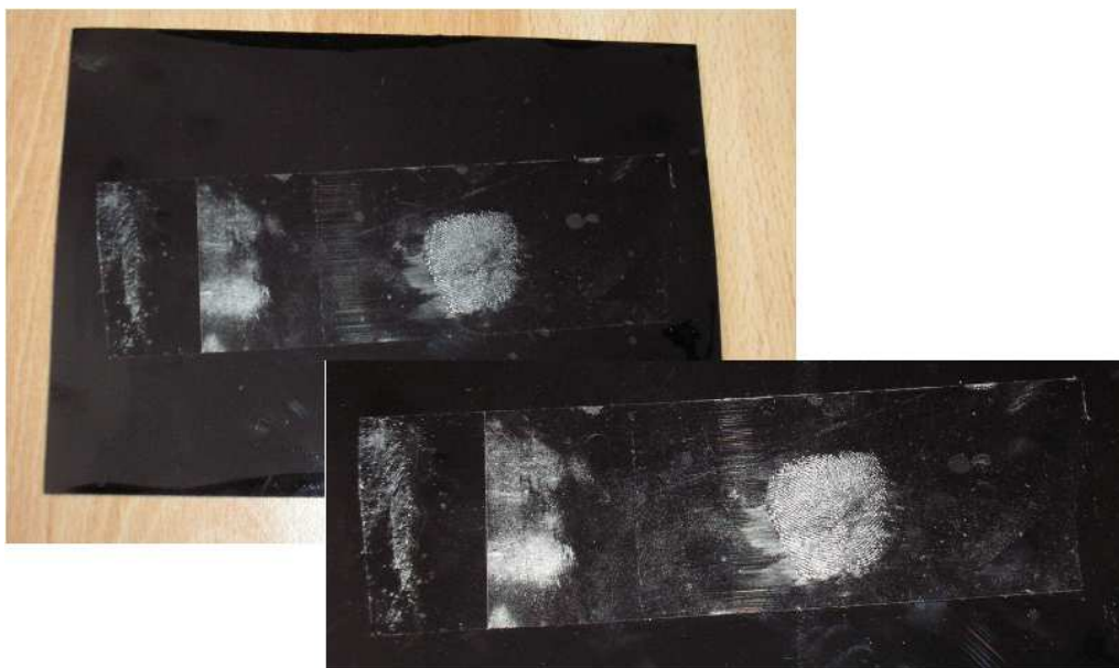
Obr. 54. Stopa zaistená lepiacou páskou
