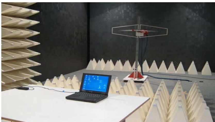
Obr. 12: Úplně bezodrazová komora (FCA) [14]
