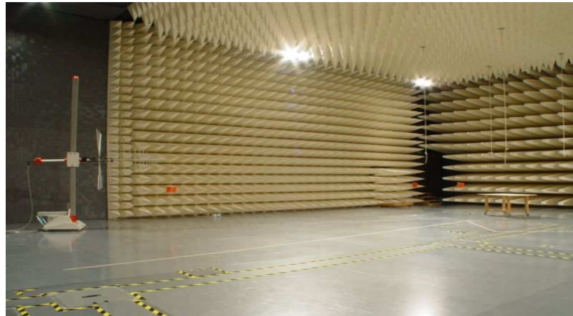
Obr. 13: Částečně bezodrazová komora 10 m [14]
