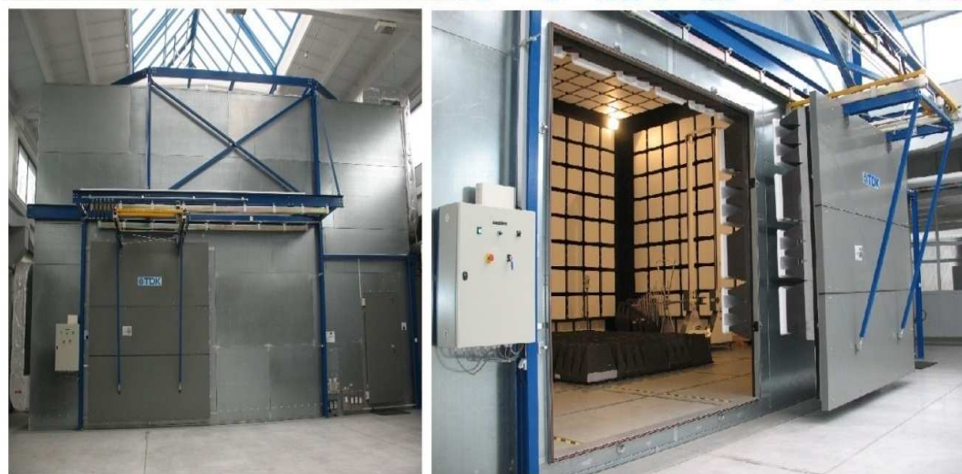
Obr. 10: Semianechoická komora z venku [12]
