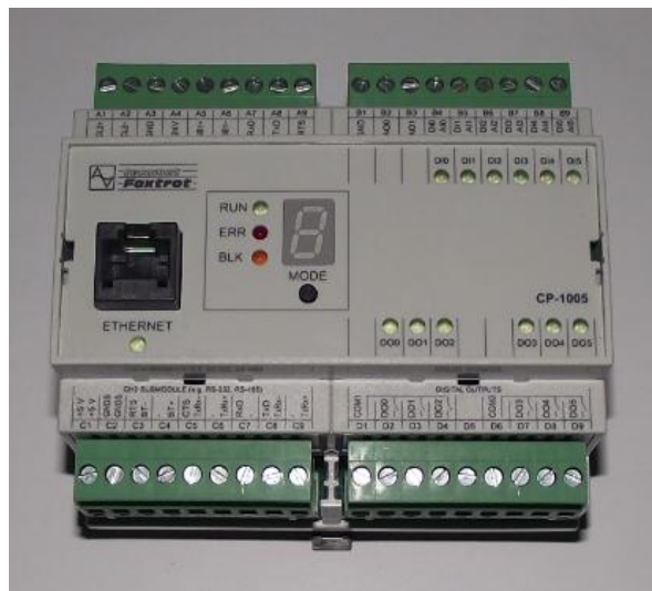
Obr. 15. PLC Teco Foxtrot CP – 1005
