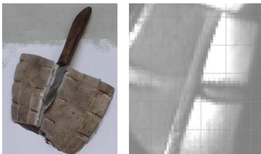
Obr. 50. Nůž ukrytý v botě a terahertzový snímek
