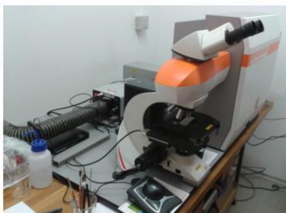
Obr. 24. Ramanův spektrometr a umístění vzorku pod mikroskopem
