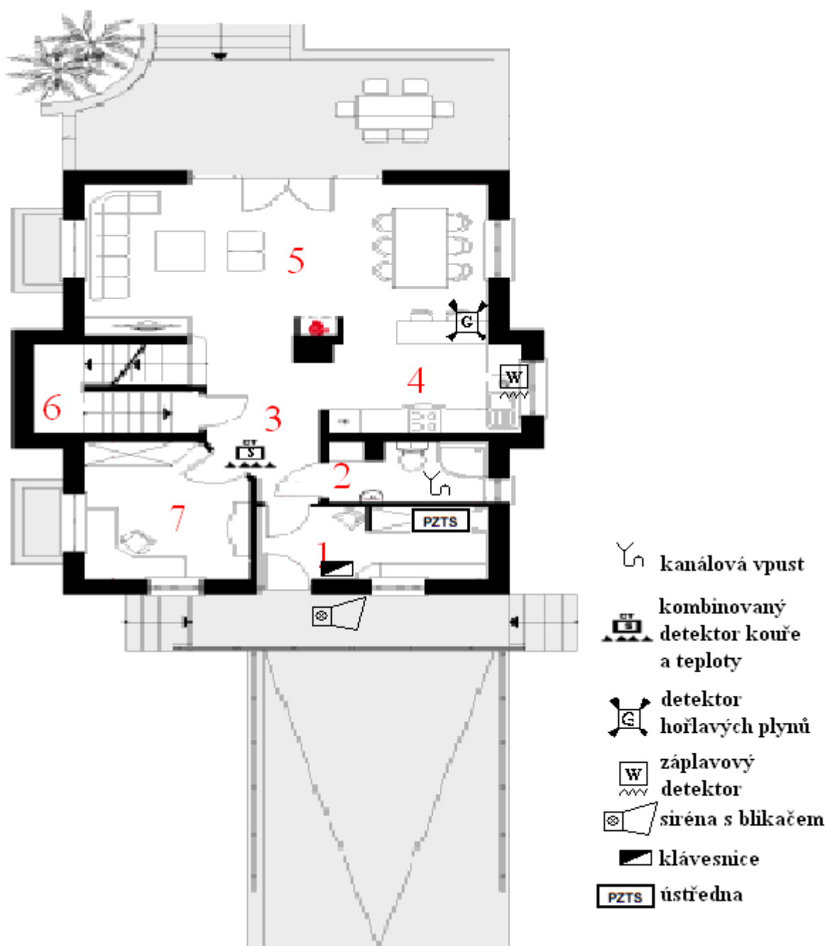
Obr. 21 Předpokládané umístění prostředků proti haváriím v přízemí
