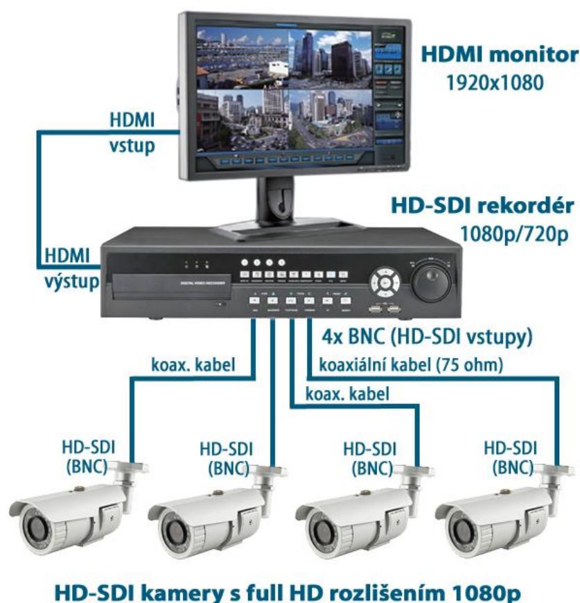
Obr. 16 Zapojení HD-SDI kamerového systému [25]
