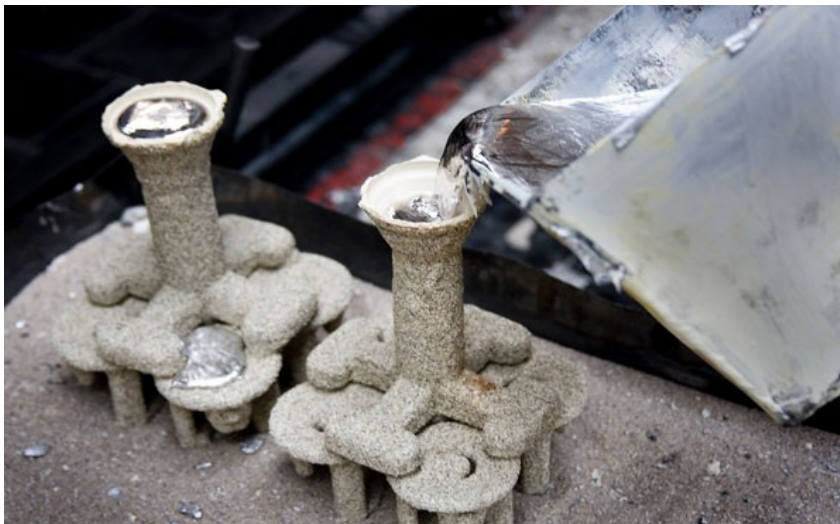
Obr. 12: Lití hliníkových slitin do skořepinových forem
