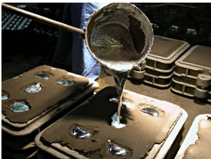
Obr. 11: ukázka lití do pískových forem [6]
