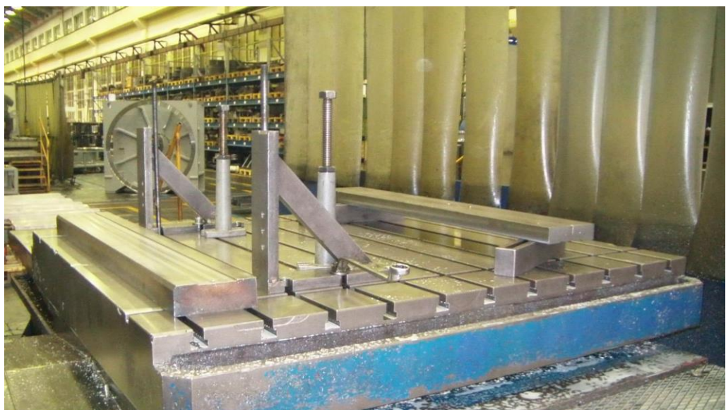
Obr. 27. Nový upínací přípravek 45547 SPF připraven pro upnutí pólu
