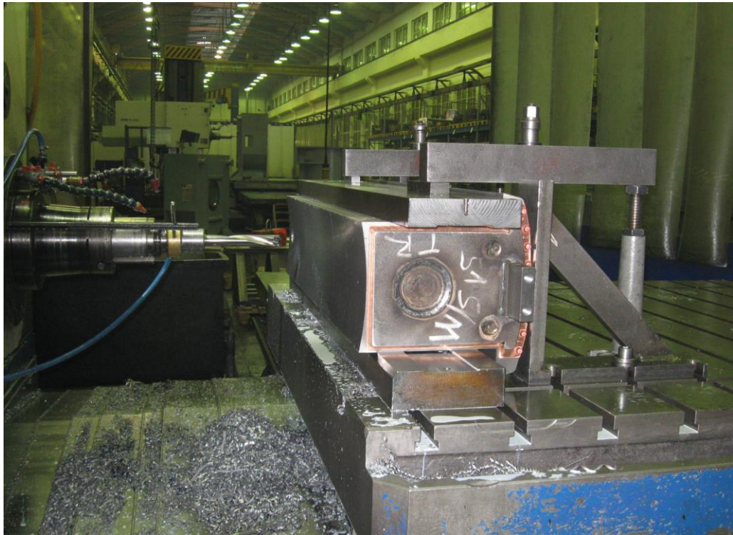
Obr. 28. Upnutý pól v novém přípravku 45455 SPF
