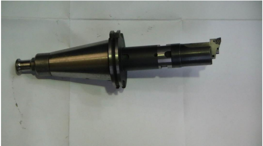
Obr. 31. Vyvrtačací tyč Ø50 pro zahloubení otvorů
