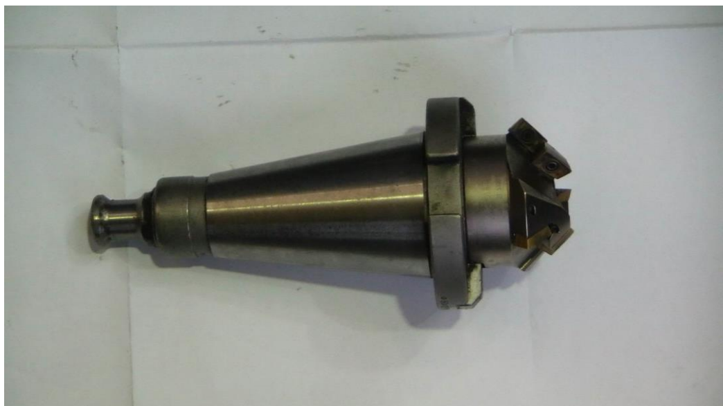
Obr.33. Fréza pro sražení vnější hrany 3 \times 45^\circ
