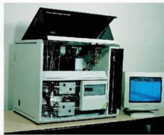
Obr. 23 - Automatický analyzátor Aminokyselin AAA 400 [79]
