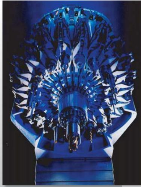
Obr. 19. Příklad pneumatického výměníku nástrojů [1]
