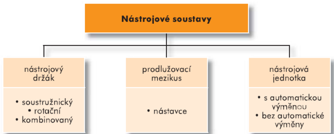
Obr. 17. Schéma morfologie nástrojových soustav pro obráběcí centra [1]
