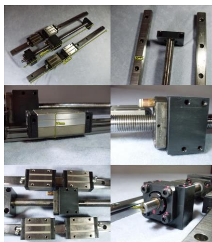
Obr. 36 NSK vedení na osu Z s kuličkovým šroubem THK.
