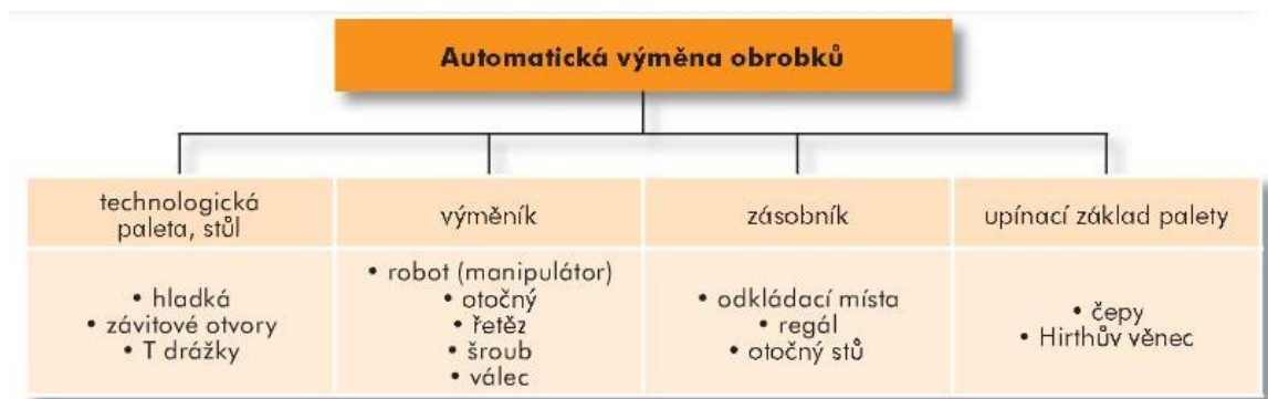
Obr. 20. Schéma morfologie automatické výměny obrobků CNC stroje [1]
