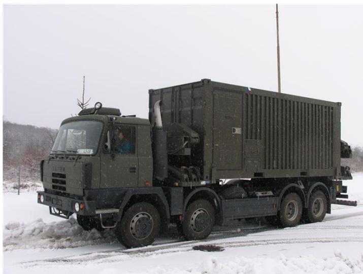
Obr. 8 - Převozní polní chemická laboratoř AL-2/CH [Zdroj: [www.vop.cz]]
