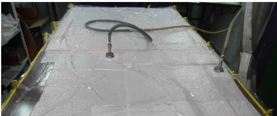
Obr. 42: Pohled na vytvořené vakuum
