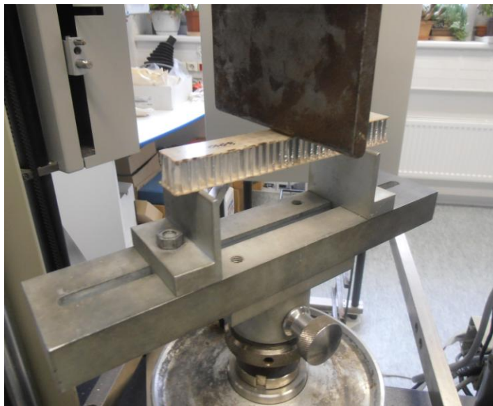
Obr. 50: Zkouška třibodovým ohybem
