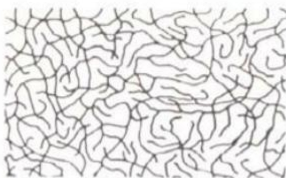
Obr.2 Struktura amorfního polymeru [3]
