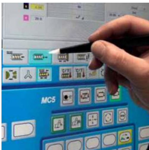
Obr. 17 řídicí jednotka vstřikovacího stroje [13]
